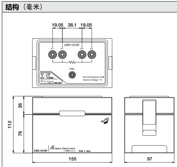
电阻材料密封在特制的壳体中，不受运输中振动的影响。
