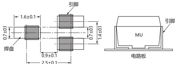
当电阻在电路板高密度的安装时, 一定量的焊膏可能接触到电阻, 影响了电阻的性能或者可靠性。为避免这种影响, 建议焊接电阻时隔离焊盘区域。
