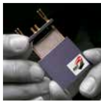
セラミックケースに気密封止
